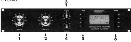
**1. INPUT (niveau d'entrée)** Ce potentiomètre détermine le niveau du signal qui entre dans le WA76 et, par conséquent, le seuil de compression. Plus le réglage est élevé, plus la compression/limitation du signal est importante.
